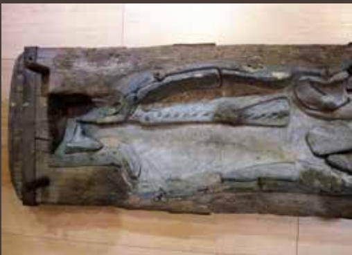
Moule en bois de l'époque d'Auzoux garni de multiples masselottes ou « noyaux » d'alliage d'imprimerie dit de « Darset », nécessaires pour l'impression de la « terre » d'un modèle comportant de nombreuses dépouilles. (cliché PLT)
