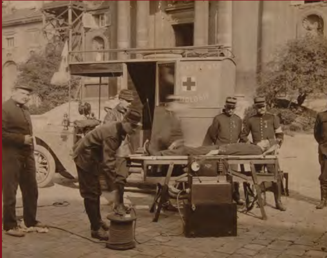
Fig. 13 à 15 : La voiture radiologique de 1914-1918, type Massiot-Philips, avec ses dessins préparatoires et sa maquette. Construite par Georges Massiot en 1912, cette voiture défila à la revue du 14 juillet 1913 à Longchamp, et figura à l'Exposition universelle en août 1914, où elle fut réquisitionnée.
