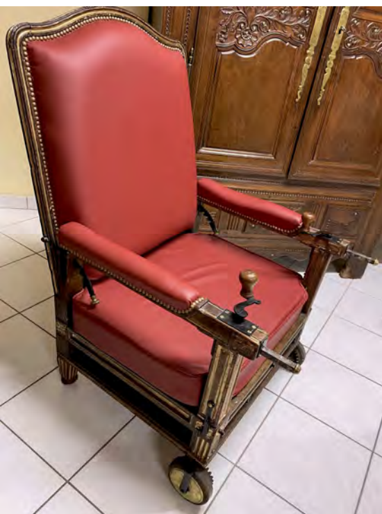
Fig. 11 à 13 : Fauteuil roulant à propulsion manuelle grâce à deux manivelles à rotation horizontale. (Cliché de l'auteur)
