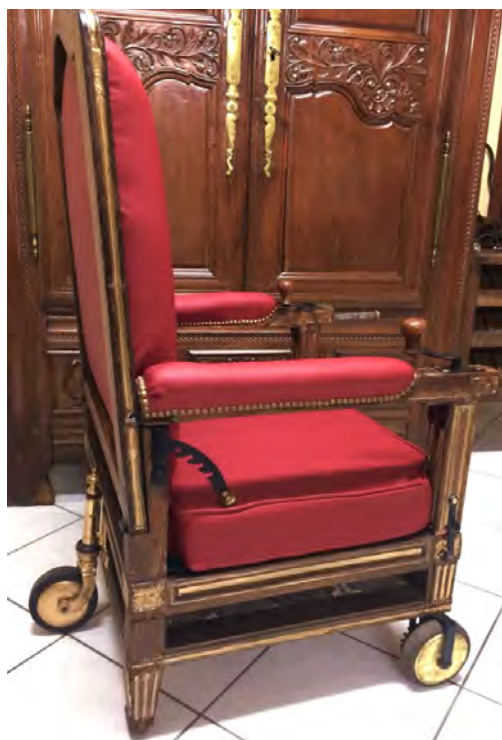
Fig. 11 à 13 : Fauteuil roulant à propulsion manuelle grâce à deux manivelles à rotation horizontale. (Cliché de l'auteur)
