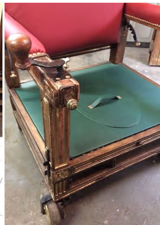
Fig. 11 à 13 : Fauteuil roulant à propulsion manuelle grâce à deux manivelles à rotation horizontale. (Cliché de l'auteur)
