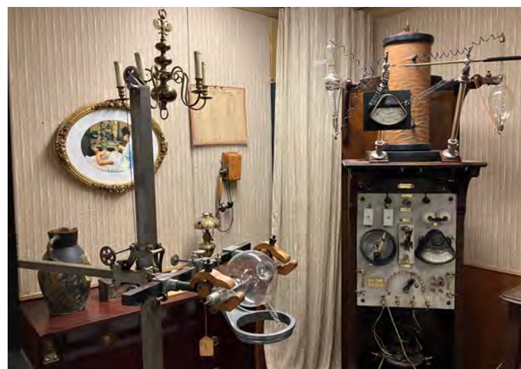
Fig. 15. Modèle élaboré par AJ D'Arsonval (1851-1940) et fabriqué par G. Gaiffe (France 1857-1943) avec un résonateur solénoïde d'Oudin.
