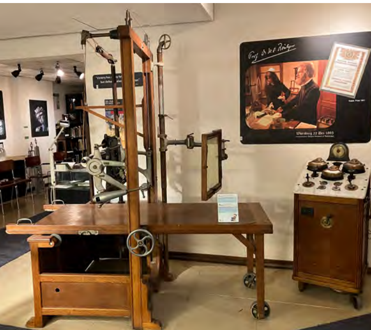
Fig. 24. Table de radiologie de la maison Gaiffe-Pilon, datée de 1907. Cette table basculante pour examens de radioscopie et de radiographie représentait l'évolution ultime des équipements utilisant le bois pour leur construction.
