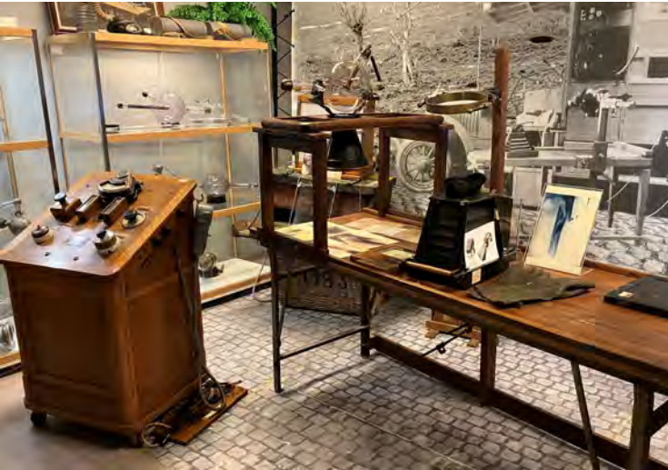
Fig. 12. Table à rayons X qui était montée dans une voiture de radiologie Massiot lors des combats sur le champ de bataille. Le tube se fixait à une distance de 52 cm au-dessus du soldat blessé allongé sur la table en bois et était entièrement démontable.
