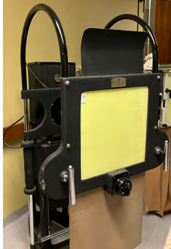
Fig. 18. Poste de fluoroscopie de l'usine « Balteau SA » à Liège (1940). Le Minibaltobloc était équipé d'un tube et d'un générateur monobloc construits sur un châssis métallique. L'écran était au format 40x40 cm. La construction était particulièrement légère et équipée d'un générateur de 80 kilovolts et 4 milliampères.
