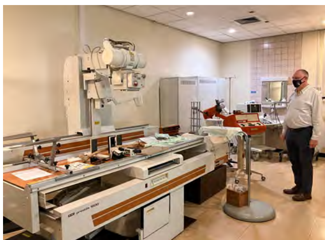
Fig. 22 et 23. Table Prestilix 1600 de la CGR qui a équipé de nombreux services de radiologie et des cabinets libéraux avec ses principaux accessoires présentée par M. R. Van den Broeck avec son pupitre de commande.
