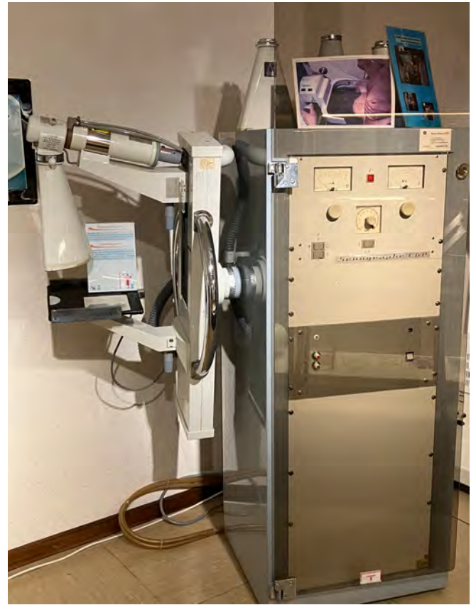
Fig. 29. Le sénographe, un des premiers mammographes équipé d'une anode en molybdène fut inventé par le Pr Charles Gros de Strasbourg en 1972 et fabriqué par la C.G.R.
