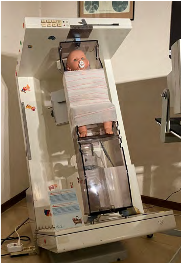
Fig. 27. Appareil de tomographie pédiatrique réalisé par la firme Ateco vers 1970 conçu par le radio-pédiatre Dominique Claus et commercialisé par Philips.
