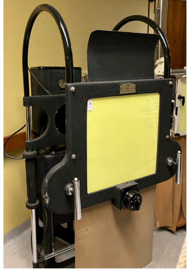
Fig. 18. Poste de fluoroscopie de l'usine « Balteau SA » à Liège (1940). Le Minibaltbloc était équipé d'un tube et d'un générateur monobloc construits sur un châssis métallique. L'écran était au format 40x40 cm. La construction était particulièrement légère et équipée d'un générateur de 80 kilovolts et 4 milliampères.
